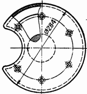
40. Обшивка крышки люка 54.29.139сб-2А
